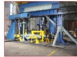
**BOGIE FATIGUE & STATIC TEST**
